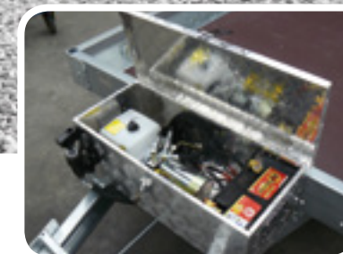
▲ Pompe électrique + batterie et pompe manuelle de secours
